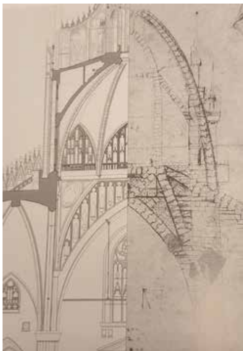
46. Confronto fra il tiburio di architettura lombarda poi realizzato (a sinistra) e l'idea di progetto di Leonardo (a destra). In foto i disegni della sezione del tiburio con le due proposte giustapposte (Duomo di Milano).
